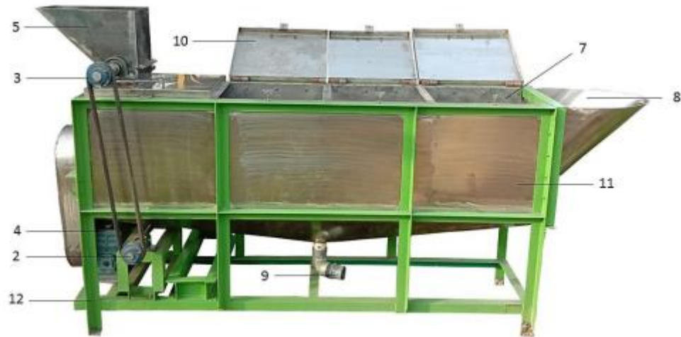
Gambar 1. Mesin pengekrak pati sagu model pengaduk berulir dengan sistem terpadu yang ditawarkan. (Reniana, dkk. 2019).
